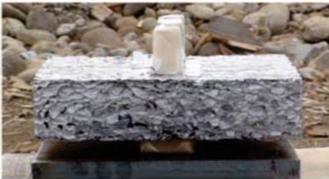
85 मिमी मोटाई और 15 मिमी आकार के बुलबुले के साथ अल्युमिनम ब्लॉक एल्यूमीनियम फोम विस्फोट परीक्षण के लिए विस्फोटक के साथ तैयार।
